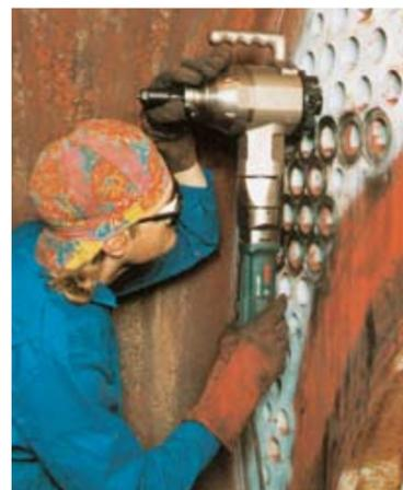
Fresatubi SUPERBOILER T4 con motorizzazione pneumatica.
